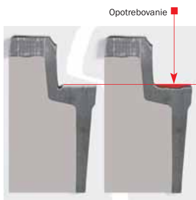
Vľavo rez novým rámom, vpravo rez rámom rovnakého typu po niekoľkoročnom používaní.
